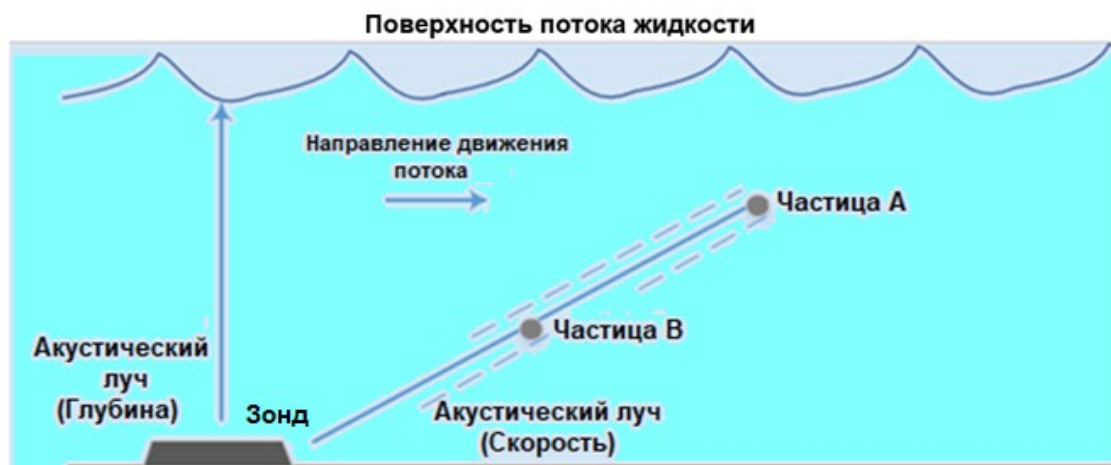
Рисунок 3.1. Пример распространения УЗ сигналов для определения скорости и глубины потока жидкости
