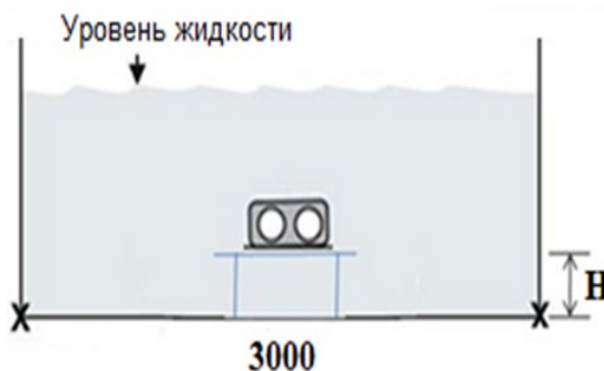
Рисунок 5.8. Прямоугольный канал с установленным зондом
