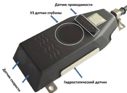
Рисунок 1.2. Комбинированный погружной датчик скорости и уровня
