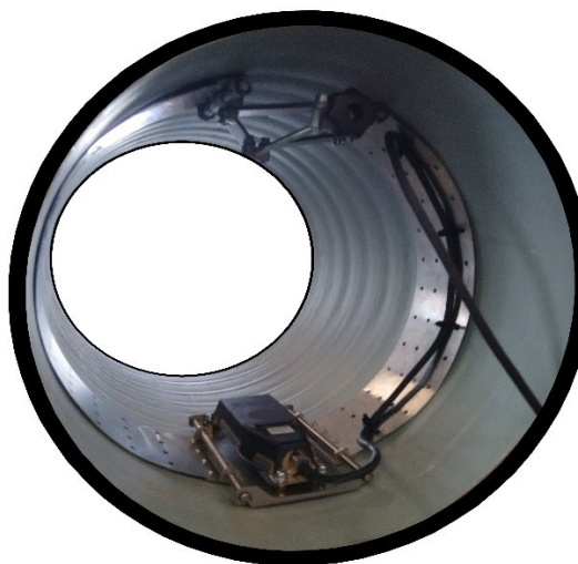
Рисунок 4.7. Расположение зонда на монтажном комплекте внутри трубы с диаметром до 900 мм.
