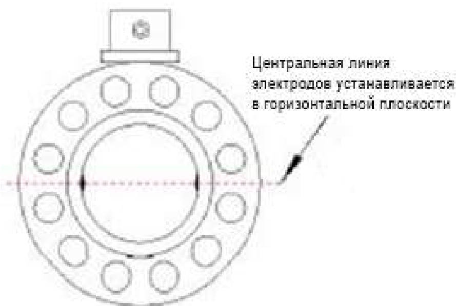
Рисунок 12. Установка расходомера в горизонтальной плоскости
