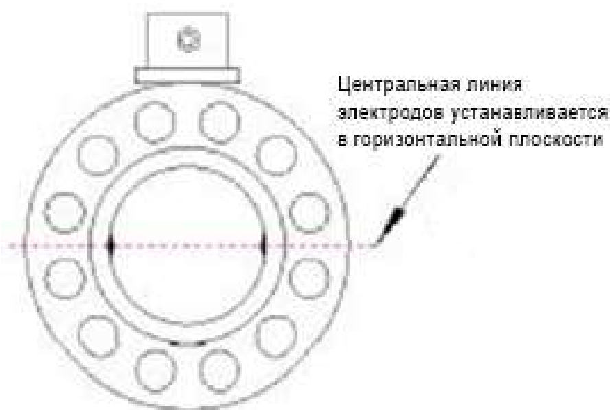
Рисунок 12. Установка расходомера в горизонтальной плоскости
