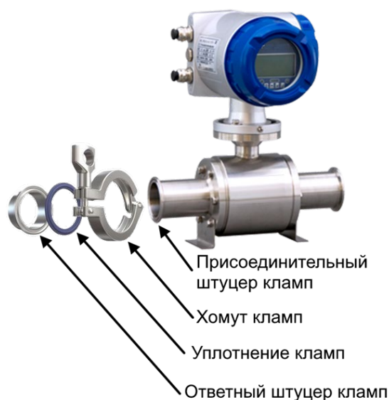
Рисунок 15.2. Соединение кламп
