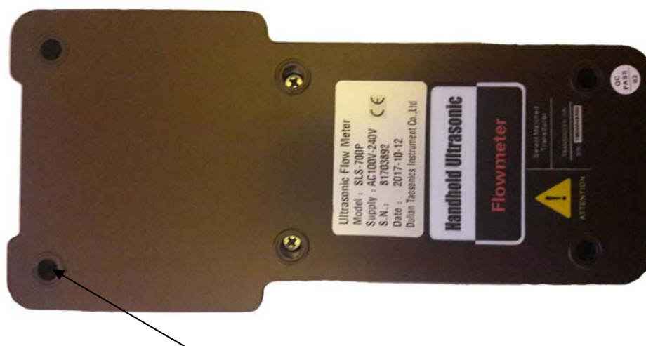
Рисунок 3 - Места пломбировки электронного блока
